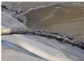
Agua de entrada al separador que contiene minerales con una concentración aproximada de 18% y una densidad de 3,5.
