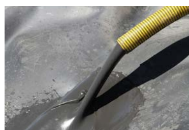
Salida de sedimentos desde el separador con aproximadamente el 80-90% de concentración *).
