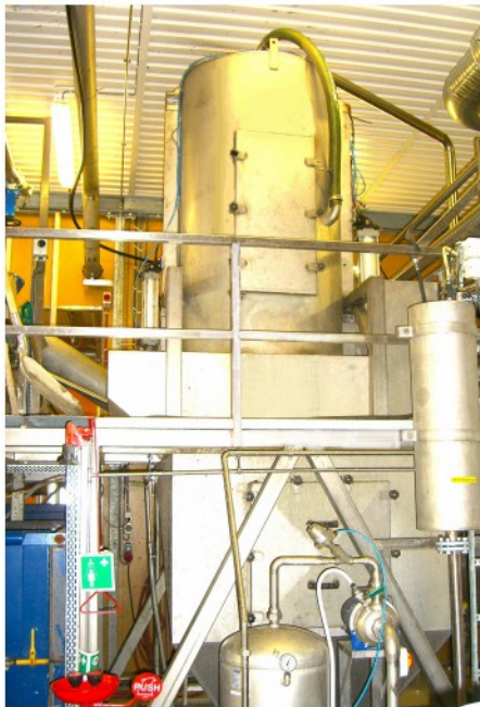
SAV 20 a 10, en un matadero, junto a un tornillo de transporte. El lodo deshidratado se junta a continuación, con estiércol y compost.
