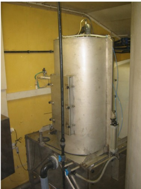
Espesador de lodos SAV 20-10 para mataderos, procesamiento de pescados etc.
