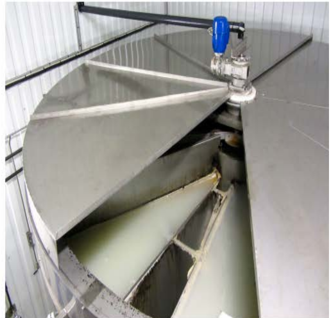
Separador FA 80 equipado con tapa giratoria.
