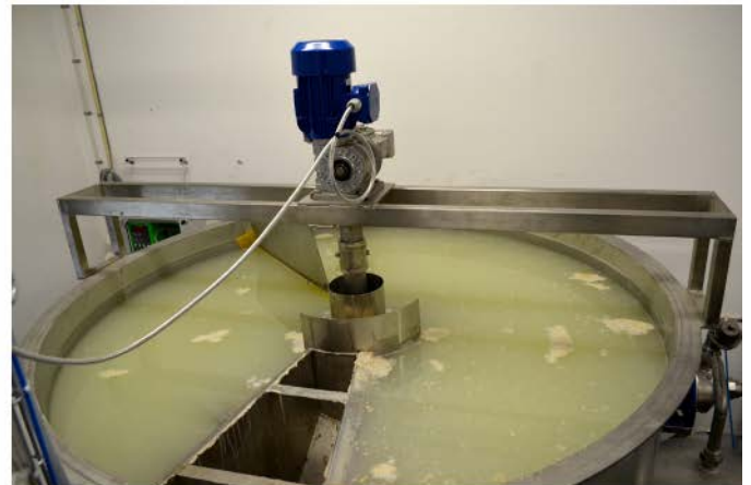
Separación de sedimentos y lodos flotantes en un separador SA20. El separador tiene juego doble de paletas, uno que empuja hacia contra la parte inferior del separador y otro que recoge los lodos de la superficie a los empuja hacia la ventanilla de lodos
